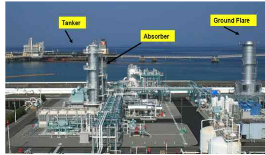
[그림 9-24] 선박에서 원유 하역 과정에서의 VOCs 흡수·회수 및 고온 산화 처리
