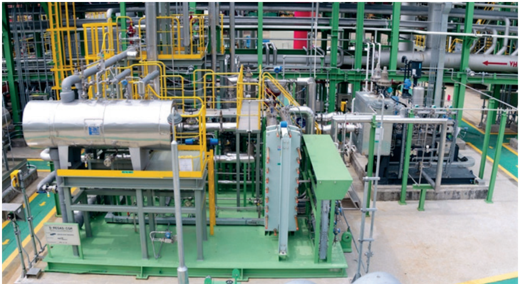
* 삼성중공업 거제조선소 내 위치한 LNG 센터에서 자체 개발한 냉열 발전 재기화 시스템(S-REGAS-CGR)의 성능 시험을 '21년 4월 완료
